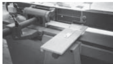
Bild 4. Skydd som täcker kuttern oberoende av anhållets läge.
