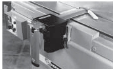
Bild 3. Nytt skydd SUVAMATIC Fördelar – automatiskt höj och sänkbart – går tillbaka i skyddsläge automatiskt – är fjädrande mot anhållet
