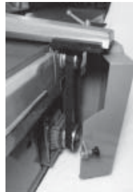
Bild 1. Öppningsbart skydd för driv-anordningen.
