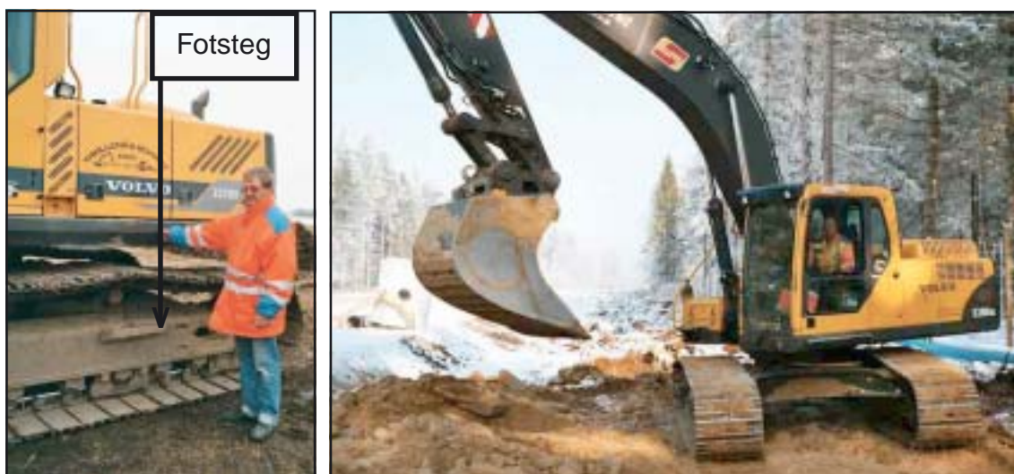
Figur 4: Avståndet från hytten till marken är ofta mer än en meter och vid arbete med bandburna grävmaskiner vill maskinförarna ofta ta sig ur maskinen när den står så att "fotstegen" inte kan användas.
