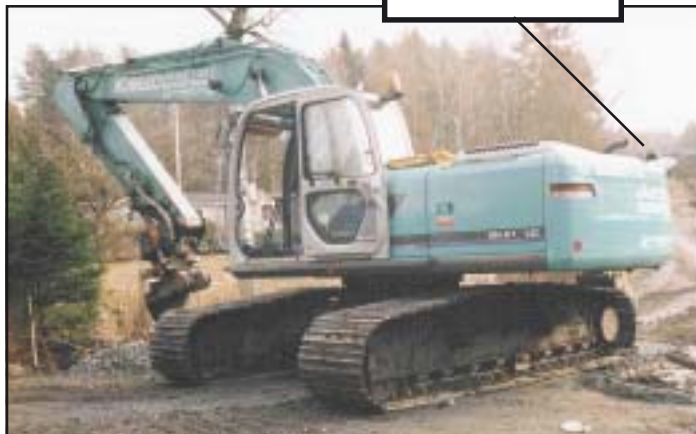
Figur 10: Backkamera monterad bak på maskinen med display i hytten.
