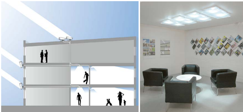
Figur 57. Dagsljuset fångas upp av solfångare utomhus och leds in i byggnaden via fiberoptik till lokaler i behov av dagsljus.
