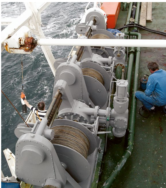
Spel och vinschar kan ha friktionsbelägg som innehåller asbest.
