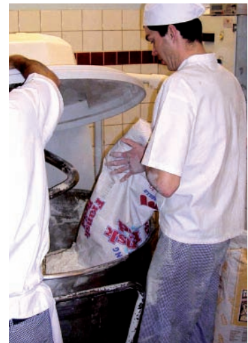
Säck nära trågets botten vid tömning
