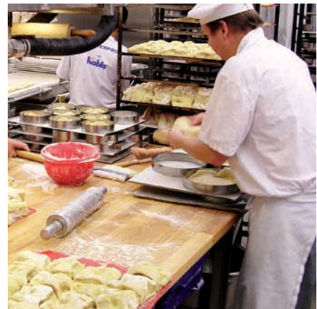
"Dammfritt mjöl" sprider sig på en begränsad yta vid doftning
