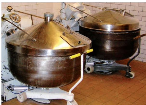
Varianter på blandare med lock med stängda inspektionsluckor
