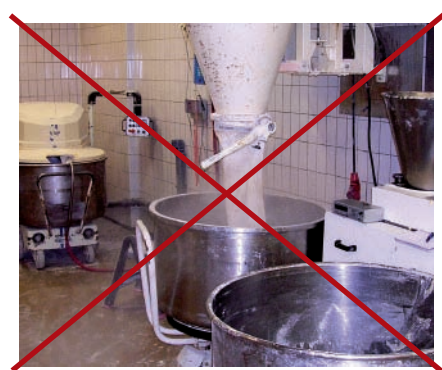
Öppen tömning från silo i tråg
