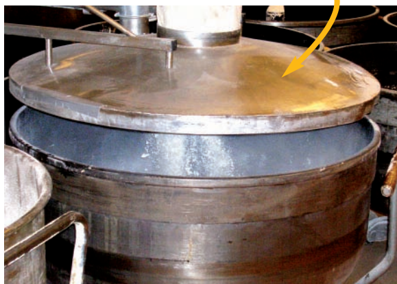
Inkapsling i form av lock
