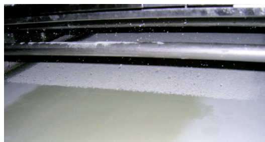
Automatisk störare som doftar mjöl i tunt lager. Allt mjöl tas upp i processen.
