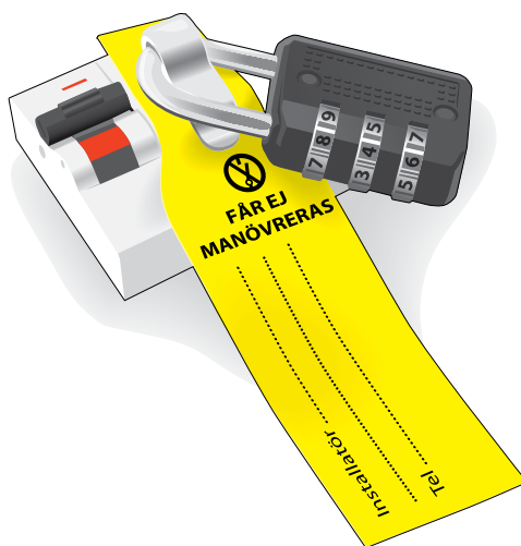
Figur 6. Exempel på låst dvärgbrytare som markerar att elarbete pågår och vem som är ansvarig. Den underlättar för andra inom arbetsområdet och blockerar mot tillkoppling.
