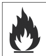
Figur 5. Kläderna ska vara märkta enligt illustrationen ovan vilket betyder att de är certifierade för skydd mot elektrostatisk uppladdning (EN 1149), termiska risker orsakade av ljusbåge (EN 61482), hetta och flamma (EN ISO 14116 (EN 533)), samt för god synbarhet (EN 471).
