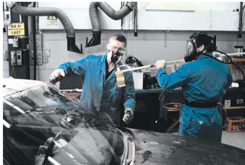
Demontering av vindruta med guldtråd. Vid demonteringen togs prov på halten isocyanater i andningszonen.
