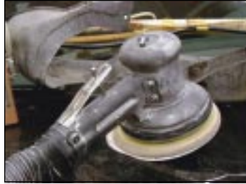
Planslipmaskin med integrerat utsug för anslutning till högvakuumanläggning.
