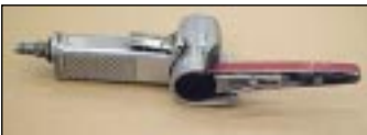
Bandslipmaskin. Om dessa slipmaskiner används – använd verktyg med integrerat utsug eller håll högvakuumslangen intill, så att dammet fångas in.
