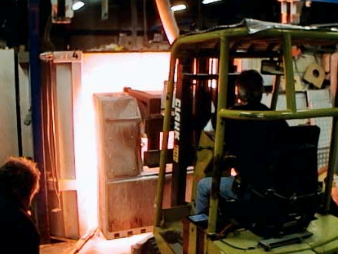
Fronten till ugn på ett glasbruk lyfts bort.
