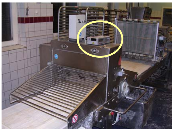
Figur 7. Mätning med direktvisande instrument (GRIMM 1.108) vid en produktionslinje. Mätningen utfördes för bedömning av behovet av åtgärder vid produktionslinjer.
