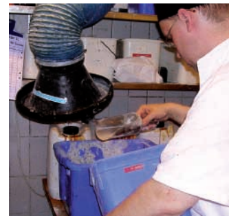
Punktutsug används vid tömning från silo i tråg samt invägning av övriga ingredienser
