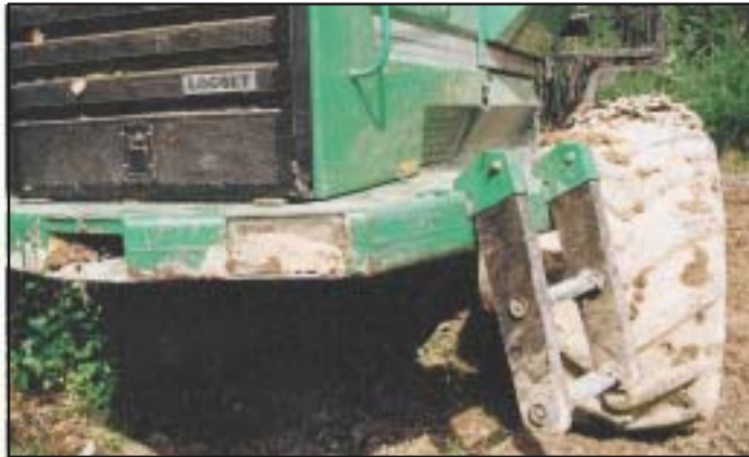
Figur 8: Specialutvecklad gummistege från Forest Maskinförsäljning AB.
