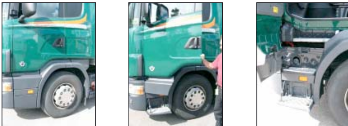
Figur 7: Mekaniskt styrd ner- och uppfällning av fällbart fotsteg.
